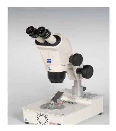
Spezial Mikroskop zur Diamantgraduierung.
